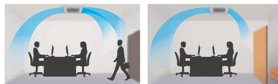
Elevato comfort, l'aria fredda non lambisce direttamente le persone.
